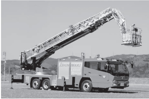
屈折梯子付消防自動車整備事業
